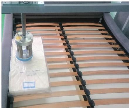
**Slika 2.** Ispitivanje kreveta vertikalnim udarom u LIND laboratoriji
