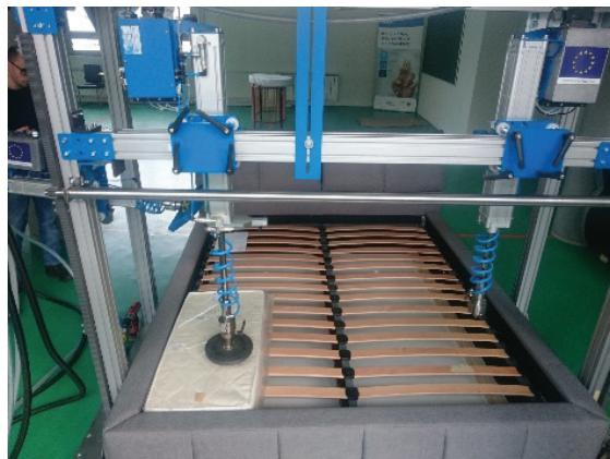
**Slika 1.** Ispitivanje izdržljivosti kreveta u LIND laboratoriji
